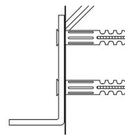
コンクリートドリルで下穴をあけ、コンクリート用プラグ(市販品)を壁面に打込み、ビスでL金具を固定します。
