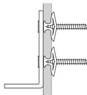
ボード用アンカー(市販品)を壁面に固定し、ビスでL金具を固定します。
